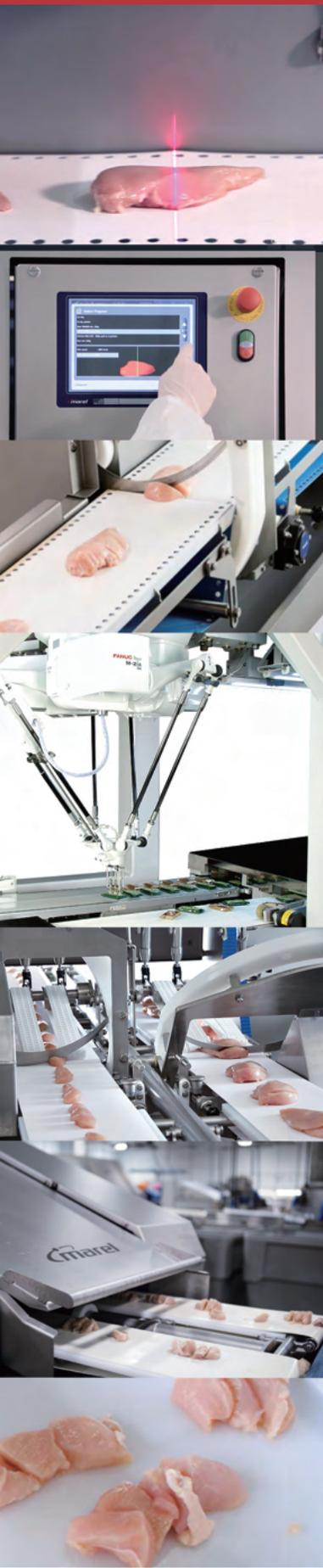
オペレーターが原料を投入したら、カット機① (I-Cut11) で一次カットします。同重量で2等分に切断された原料をパラレルリンクロボットが回転・ピッチ調整します。カット機② (I-Cut122) でからあげサイズに鶏肉の切断を行う事が可能です。
