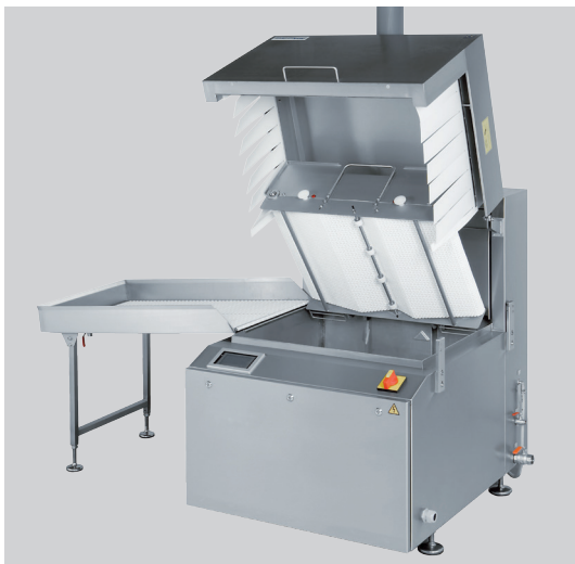
ディッピングプラットフォーム 排水なしでアクセスが可能。カバーとプラットフォームは、上部にスイングし、簡単にシンクの清掃ができます。
