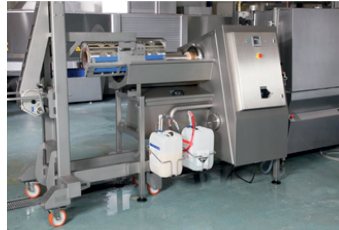
洗浄ユニットでポーショニング・ドラムの内外を自動で洗浄
